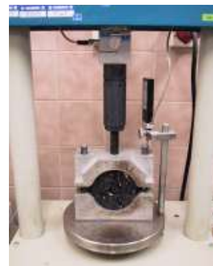
Obr. č.3: Marshallův lis se zkušebními čelistmi
